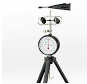
図2 携帯用風向風速計
