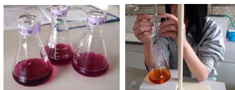
CODの測定 (アルカリ性過マンガン酸カリウム-ヨウ素滴定法)
