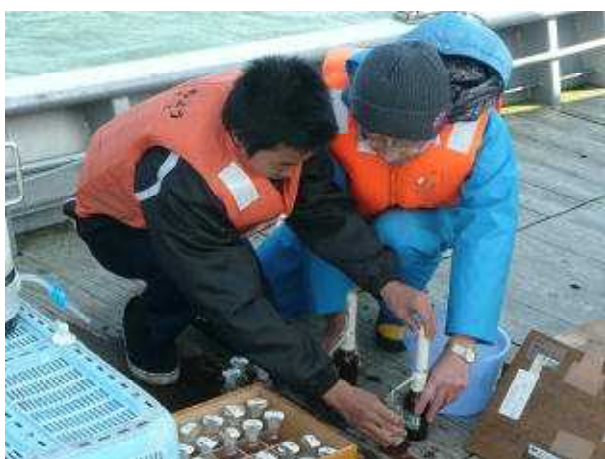
(写真12) 酸素固定の様子
