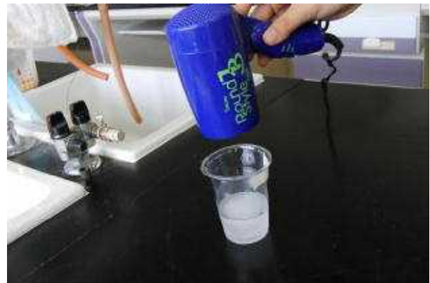
図 12 凍った電解質水溶液をドライヤーで融かす
