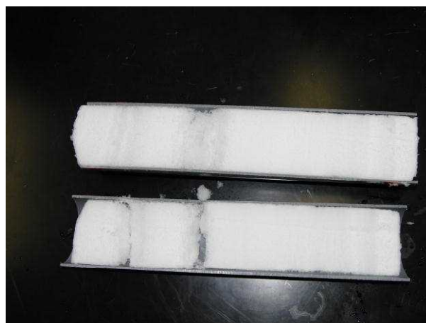
図9 しまった雪とザラメ雪の2層構造
