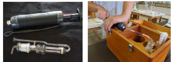
吸引器(上)とガス発生管(下)
