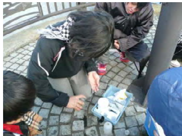
(写真3) 溶存酸素測定の様子
