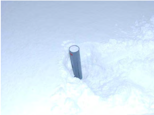
図9 塩ビ管を差し込む
