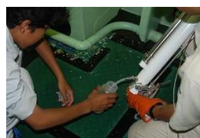
ナンセン転倒採水器による採水
