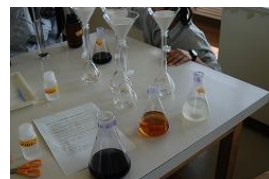
逆滴定法によるCODの測定
