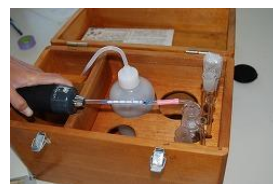
検知管による硫化水素の測定
