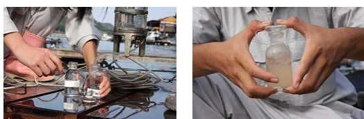
ウインクラー・アジ化ナトリウム変法によるDO固定
