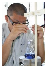
ウインクラー・アジ化ナトリウム変法によるDO固定
