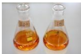
ウインクラー・アジ化ナトリウム変法によるDO固定
