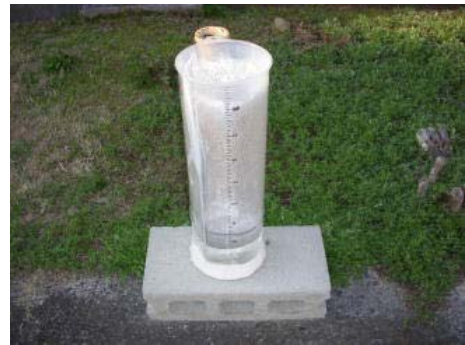
設置した雨量計（調査ポイント1）
