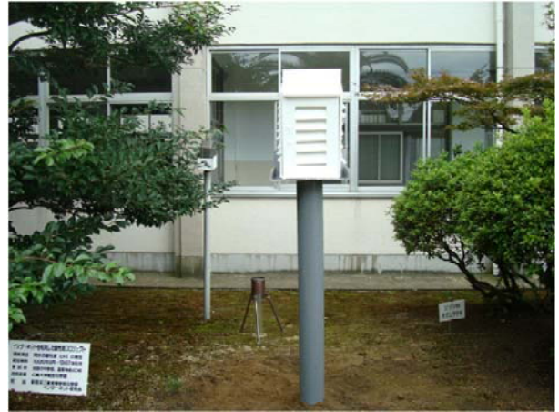
写真8 簡易百葉箱の製作（完成）
