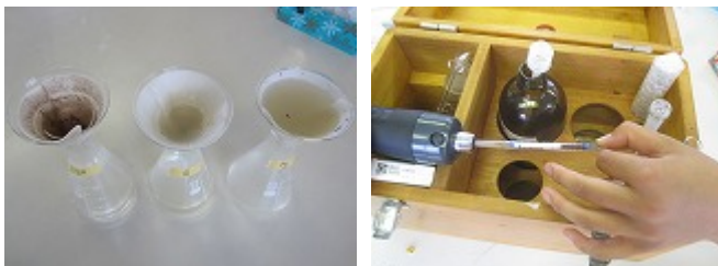
泥のろ過 検知管による硫化水素量測定
