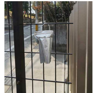
図6 NO 2 測定キットの設置
