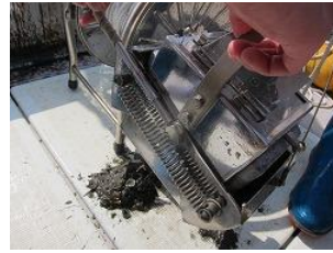
エクマンバージ採泥器による採泥の様子
