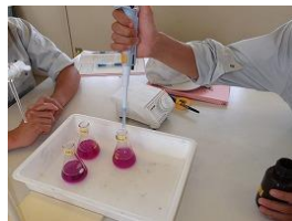
CODの測定 (試薬の混合)
