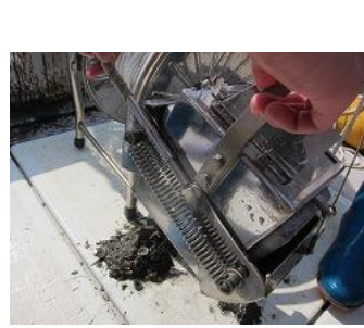
エクマンバージ採泥器による採泥の様子
