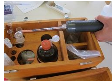
検知管による硫化水素量測定の様子
