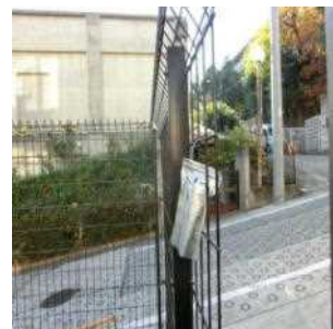
図7 NO 2 測定キットの設置
